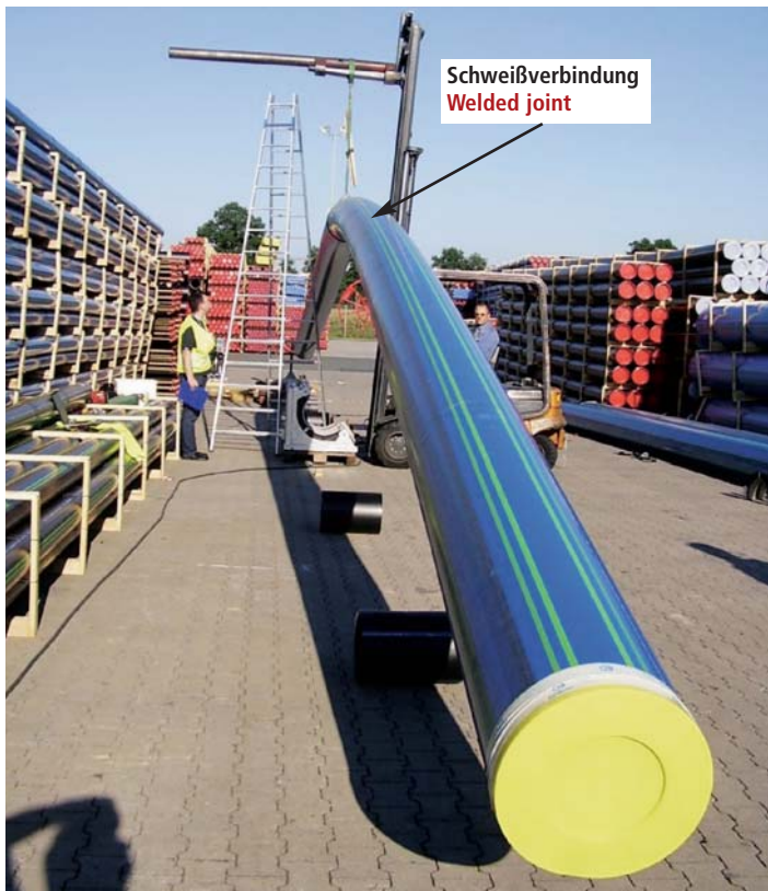
Bild 4: Mechanische Belastung der Schweißverbindung
