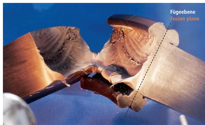
Bild 1: Heizelementstumpfschweißverbindung nach dem Zeitstandzugversuch (Wanddicke 45 mm)
