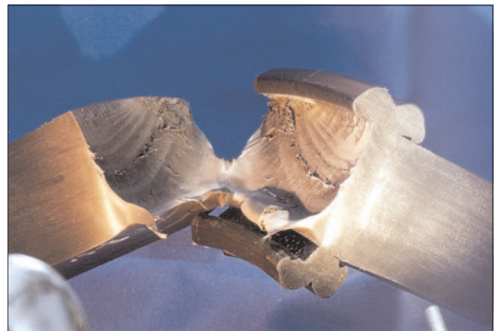
Bild 6: Bruchverlauf nach dem Zeitstandzugversuch an der Schweißung eines Rohres aus PE 100 (500 mm x 48 mm)
